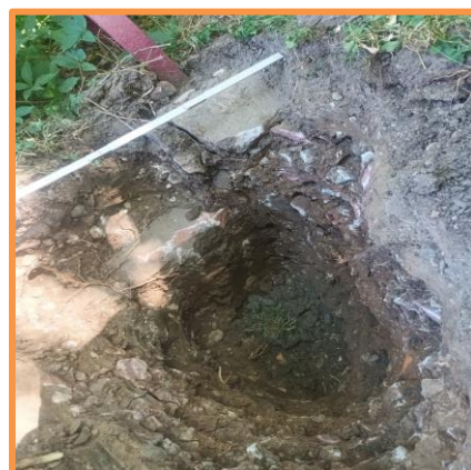
Photographies des 2 reconnaissance de fondations (RF1 à gauche, RF2 à droite)
